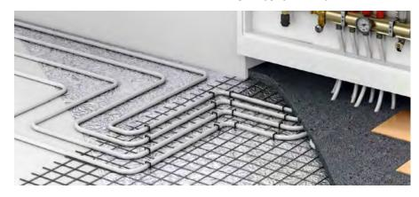
менее чем на 20 мм. Перекрытие застилается полиэтиленом, а затем накладываются фольгированные или вспененные теплоизоляционные материалы. При выборе фольгированного материала важным аспектом является присутствие защитной алюминиевой плёнки. Это убережёт теплоизоляцию от разрушения в щелочной среде бетона. Чтобы придать монолиту прочности, в основу стяжки помещают арматурную сетку.
